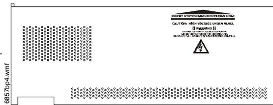
**O Painel de Revestimento da Bateria BP-4 cobre a Fonte Principal de Corrente e as baterias no mesmo. Sòmente um BP-4 é necessário por gabinete.**
